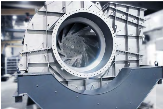
Schwerer Industrieventilator, Bild: POLLRICH GmbH
